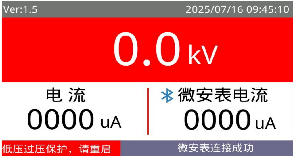
图 3-6 低压过压保护
