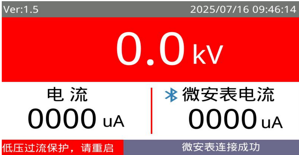
图 3-7 低压过流保护
